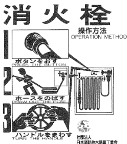
第2-16図 1号消火栓の使用方法表示例(1)
