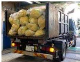
重機等を使用して積み込む場合はフレコン袋を利用し、重機が袋等に触れないように積み込みを行います。運搬時には車両に飛散防止シート掛けを行い、車両の側面に産業廃棄物の運搬が分かるように許可番号を明示し運搬します。保管所・積替え施設を経由せずに最終処分場まで直送します。アスベストの最終処分は必ず「特別管理産業廃棄物処分業許可」を受けた処理場で処分します。
