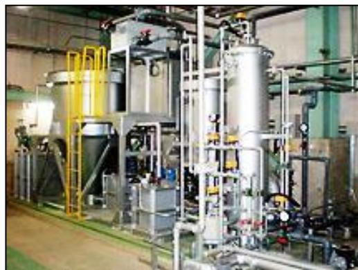
図8 凝集沈殿処理装置の例
