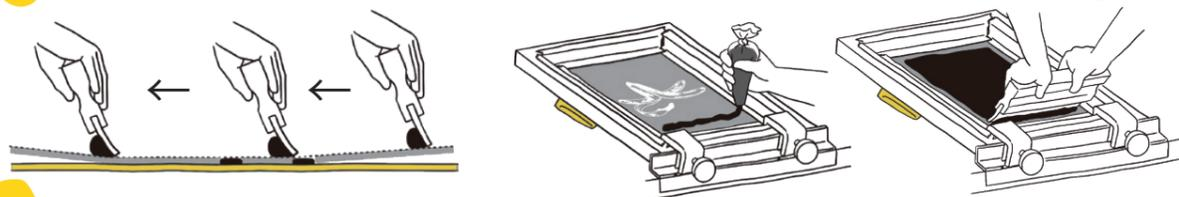
シルクスクリーンは、あな(孔)のあいた所からインクが落ちる孔版印刷の原理が使われています。印刷時はスキージと呼ばれるヘラを使ってインクを下に落とします。
