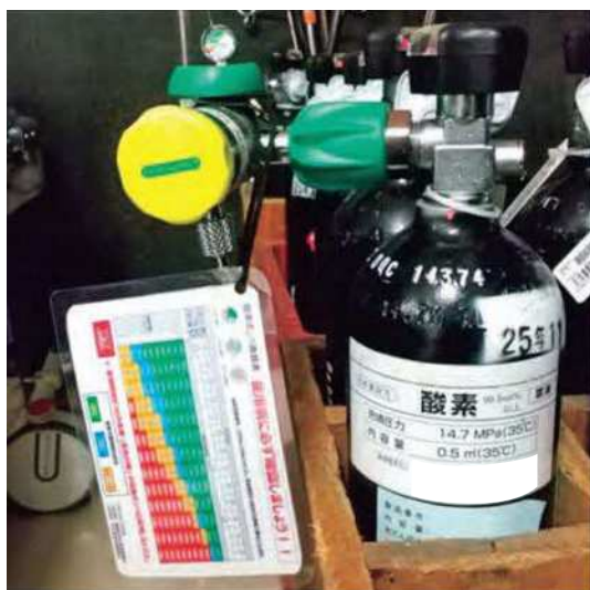
図表Ⅳ－２－２２ 酸素ポンベに使用可能時間早見表を設置した例
