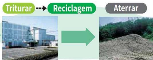
Após a trituração em pequenos pedaços realizada na instalação de britagem, as sobras de metal que podem ser coletadas são recicladas, e os demais são incinerados ou aterrados.
