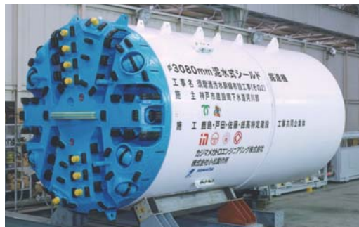
須磨浦汚水幹線(その2)シールドマシン
