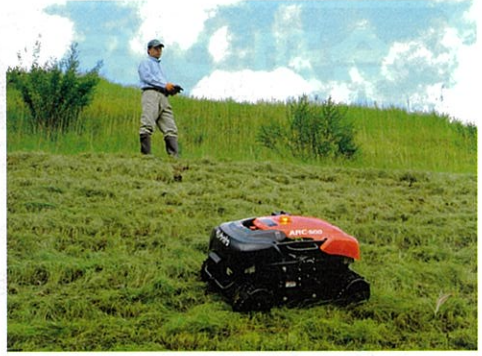
リモコン式自走草刈機 人が作業し難い急傾斜のような危険な場所での除草作業もリモコン操作で安全に実施可能。軽四輪トラックに搭載可能。作業効率は慣行作業の約2倍。
