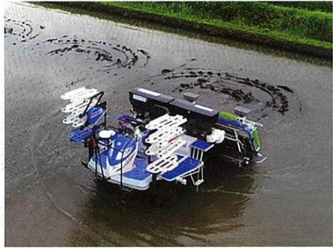
自動運転田植機 田植え作業と苗補給を1人で実現可能。最高速度で植付作業を行っても熟練者並みの直進精度と作業精度を維持できる。2020 年度以降実用化
