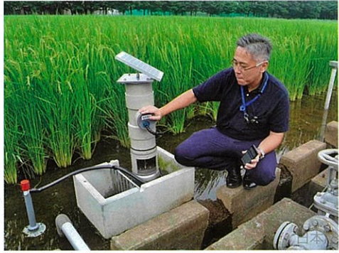
水田の水管理システム センシングデータや気象予測データにより、水管理の最適化及び省力化を実現。水管理労力を80%削減、気象条件に応じた最適水管理で減収を抑制。
