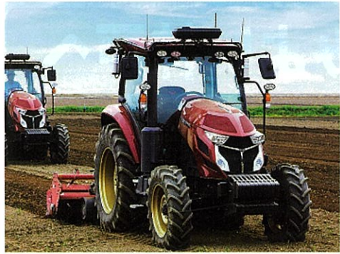
自動走行トラクター 限られた作期の中で1人当たりの作業可能な面積が拡大し、大規模化が可能。ヤンマー(株)ロボットトラクター価格: 1,214 ~ 1,549 万円 2018 年販売
