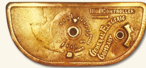
神戸市電に使用されていた 運転台のコントローラーボード
