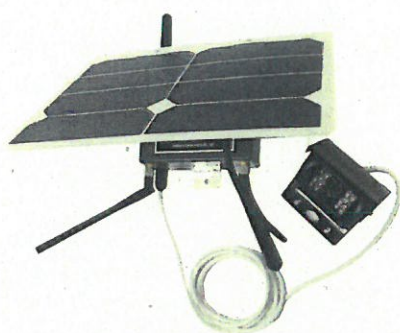
導入予定の撮影モジュール (カメラ、太陽電池、LTE 端末)
