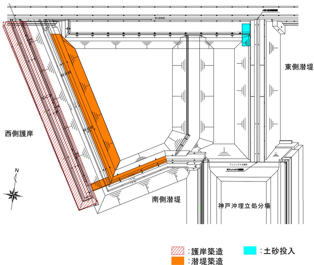
図 I -3-4(1) 潜堤築造場所及び護岸築造場所の平面図
