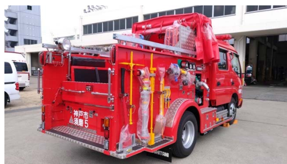
資材搬送ポンプ車（神消須磨5）
