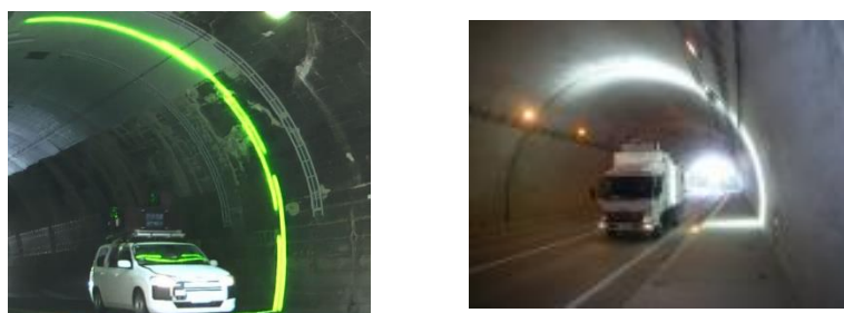
図 5 走行型計測による画像計測状況
