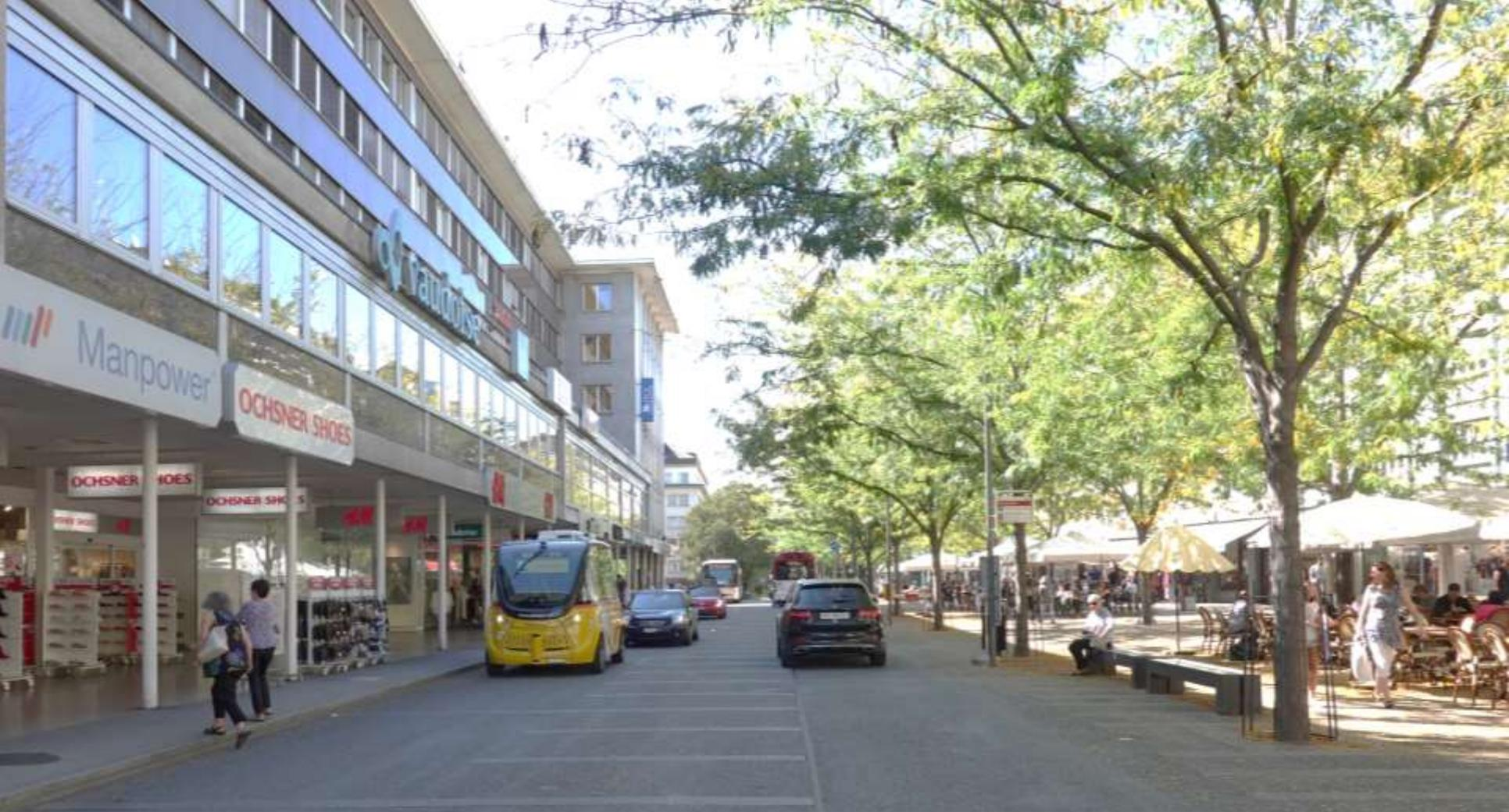
**セミトランジットモールを走行する自動運転バス：駅と中心街を結ぶ循環ルートと中心街と住宅街を結ぶルートの2系統が運行。優先信号により車両が接近すると青信号に変わるよう工夫。2016年から始まり、3年以上走行。**
