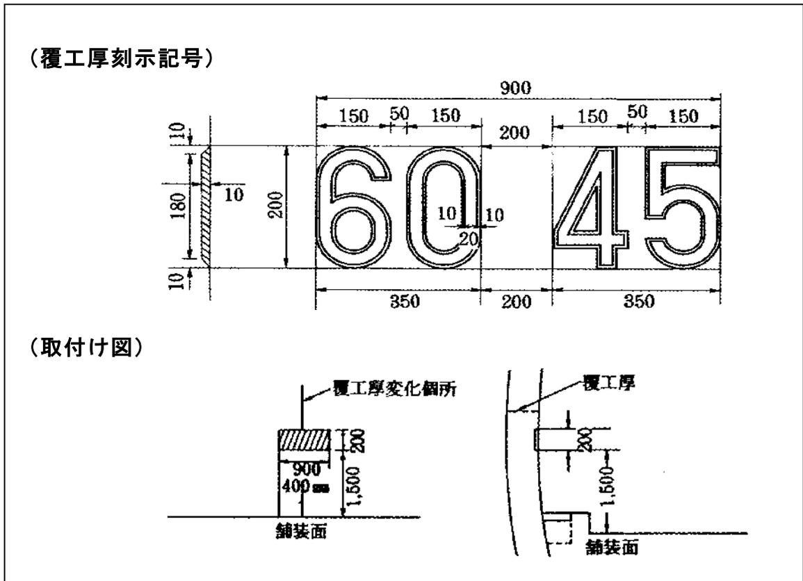
図6-1 覆工厚変化箇所の刻示標準図
